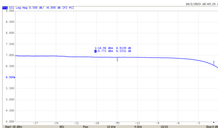
Figura 2 - Medición de S21 que muestra la compresión
