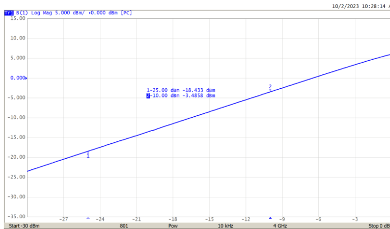
Figura 1 - Barrido de potencia a 4 GHz
