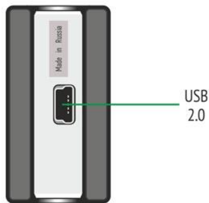
Figure 2.7 Mini B USB port R54
