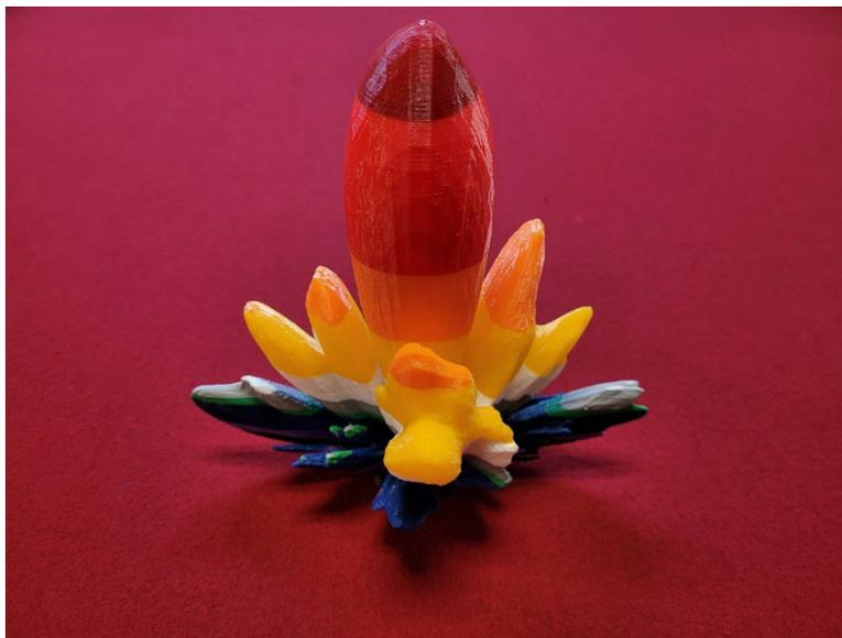
*Figura 5 – Patrón de Radiación Impreso en 3D*
